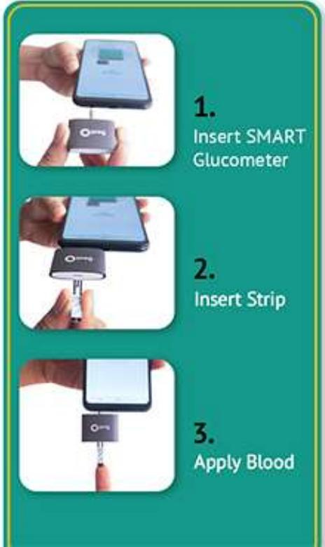
1. Insert SMART Glucometer
